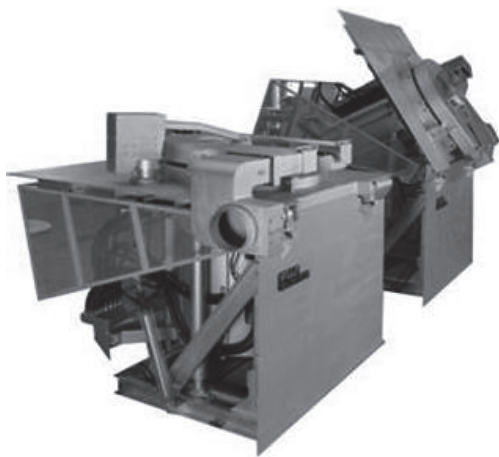
図-2 るつぼ形誘導炉本体の外観 1)
